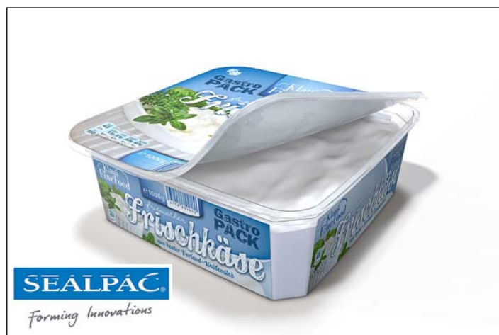
Obr. 3: Čerstvý sýr v misce EasyLid® s etiketou In-Mould. U metody EasyLid® jsou používány speciální misky s perforovaným krycím kroužkem, který se hermeticky zavaří fólií. Výsledkem svaření v rámci jediné operace je pevné spojení fólie a krycího kroužku.
