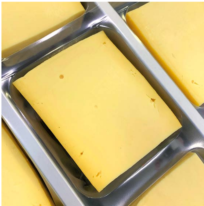
Obr. 3: Zcela recyklovatelný obal z monomerního materiálu pro balení na hlubokotažných balicích strojích
