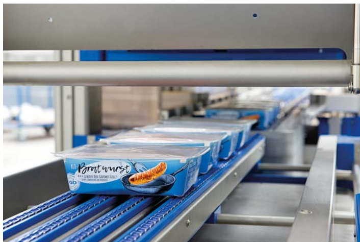
Obr. 1: Miska eTray® na bázi papíru pro MAP s vnitřní vložkou a vrchní fólií z monomerního PP
