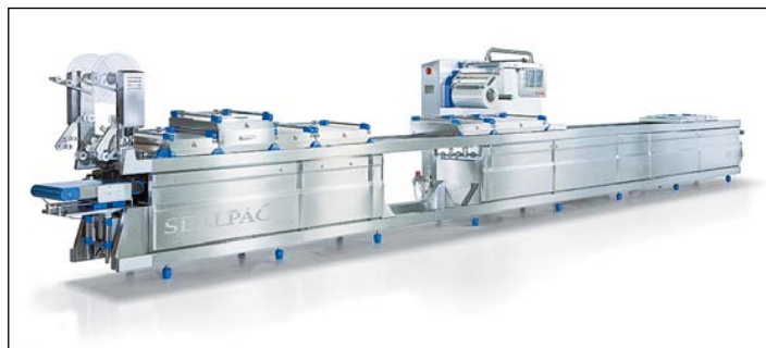
Obr. 4: Hlubokotažný balicí stroj SEALPAC RE25
