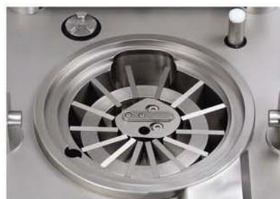
lopatkový rotor průměr: 150 mm dělení: 14
